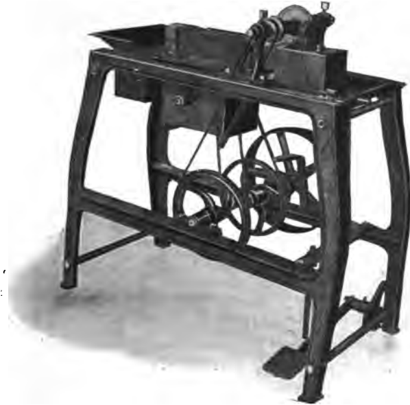
Machine Bliss servant à appliquer aux fonds de boîtes le ciment-joint.
